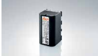
GEB222, batería de iones de litio Potente batería para todos los instrumentos TS11/12/15/16 y Flexline, receptores GS10 GNSS y Piper 100/200, 7.4V/6.0Ah Artículo: 793973
